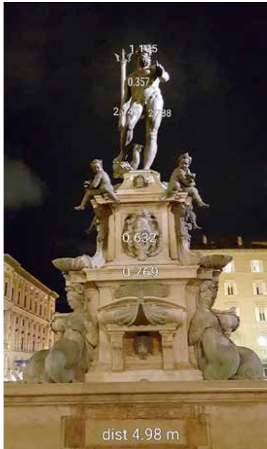
Figura 20: Misure di luminanza con luminanzometro Minolta LS-100 con apertura 1°.
