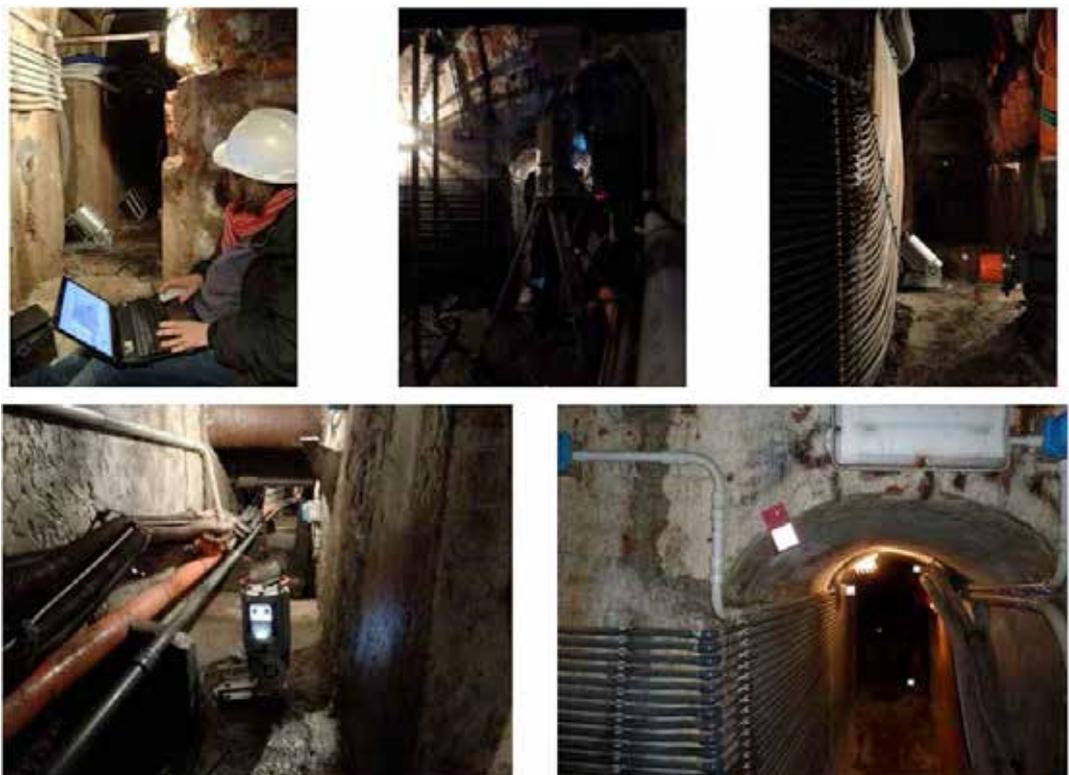
**Figura 1:** Fasi di acquisizione nel cunicolo sotterraneo con sistema laser a scansione
